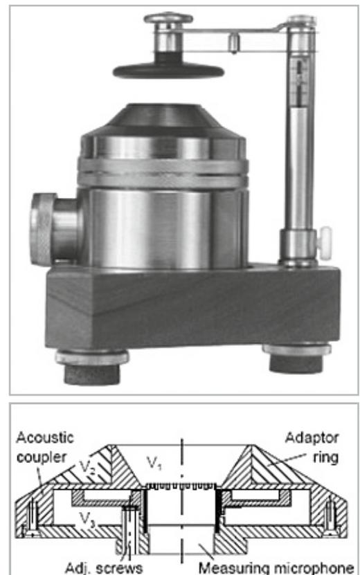
**Bild 5:** 6-cm<sup>3</sup>-Kuppler (B&K) zur Messung von Kopfhörern, bestehend aus einem Kondensatormikrofon und einem davor befindlichen Kupplervolumen (6 cm<sup>3</sup>). Der Hörer kann mit einer einstellbaren Andruckkraft von 2–10 N gegen den Kuppler gedrückt werden.
