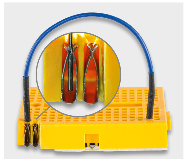
Bild 4: Die Buchsenkontakte eines Steckboards im Detail
