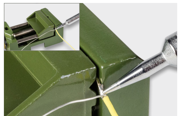
Bild 13: So lässt sich die Litze bequem mit Kontaktstift verlöten.
