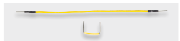
Bild 2: Unterschied zwischen flexiblen Steckkabeln (oben) und starren Steckbrücken (unten)
