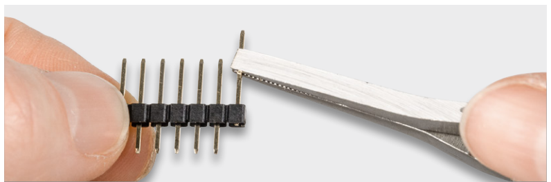
Bild 11: So werden die Stifte mit einer Zange herausgezogen.
