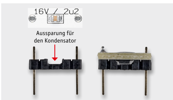
Bild 11: Für einzelne Kondensatoren muss der Körper der Stiftleisten bearbeitet werden.
