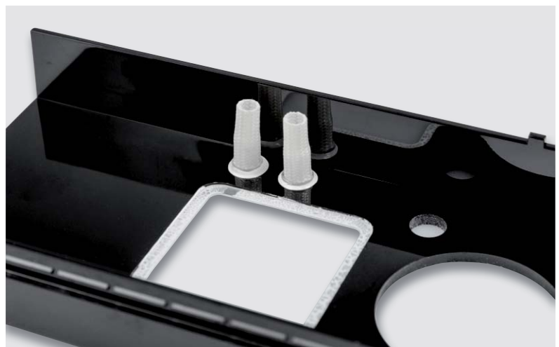
Bild 36: Montage der Isolierschlauchabschnitte zur Verhinderung von gegenseitigen Beeinflussungen
