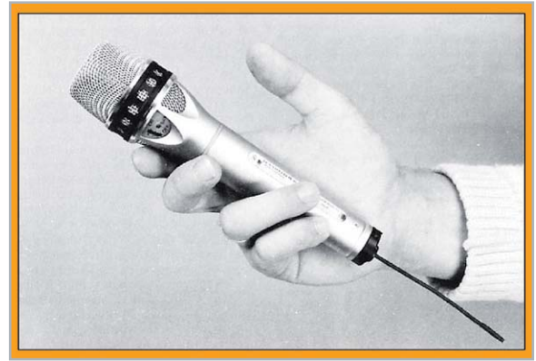
Bild 7: Drahtloses Hochfrequenz-Mikrofon (SKM 4031, Sennheiser). Es besteht aus einem Elektretmikrofon mit frequenzmoduliertem HF-Sender und kurzer Antenne.
