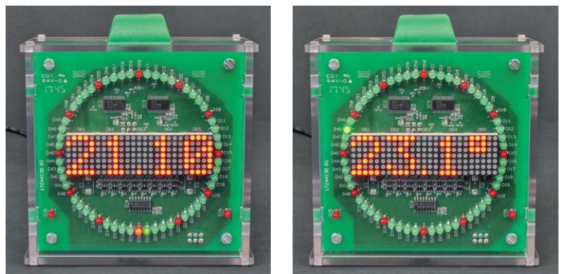
Bild 2: Mit einem kurzen Tastendruck auf die Taste TA1 wird das Datum für fünf Sekunden angezeigt.
