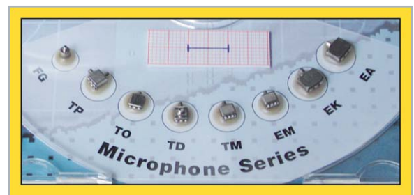
Bild 13: Beispiele für Subminiatur-Elektretmikrofone für Hörgeräte von der Firma Knowles Electronics (Illinois), aufgeklebt auf Werbematerial. Man erkennt bei allen Mikrofonen sehr deutlich die drei für Elektretmikrofone typischen elektrischen Anschlüsse.
