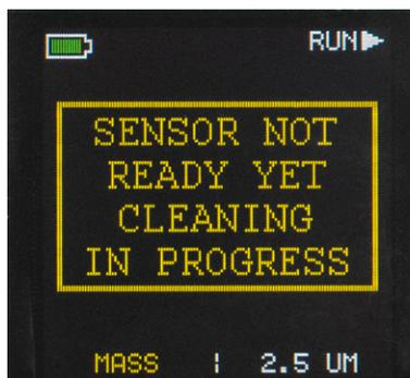
Bild 4: Reinigung des Sensors
