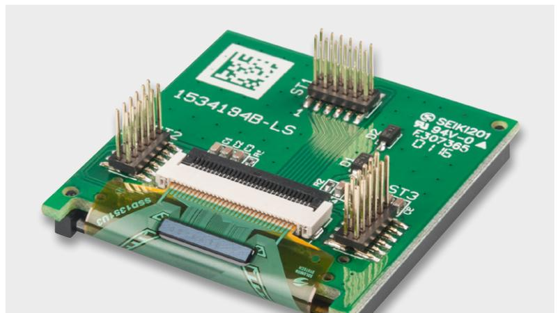
Bild 26: Fertig aufgebautes Displaymodul
