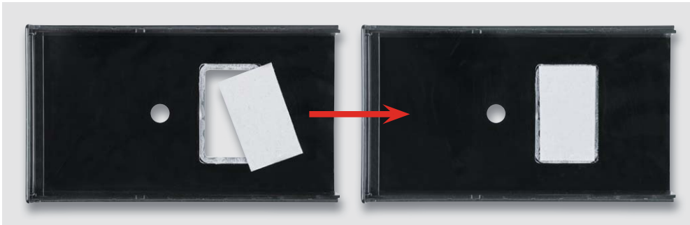
Bild 11: Ein kleines Stück Pappe (siehe Text) hilft, den richtigen Abstand des Displays zum Displayfenster einzuhalten.
