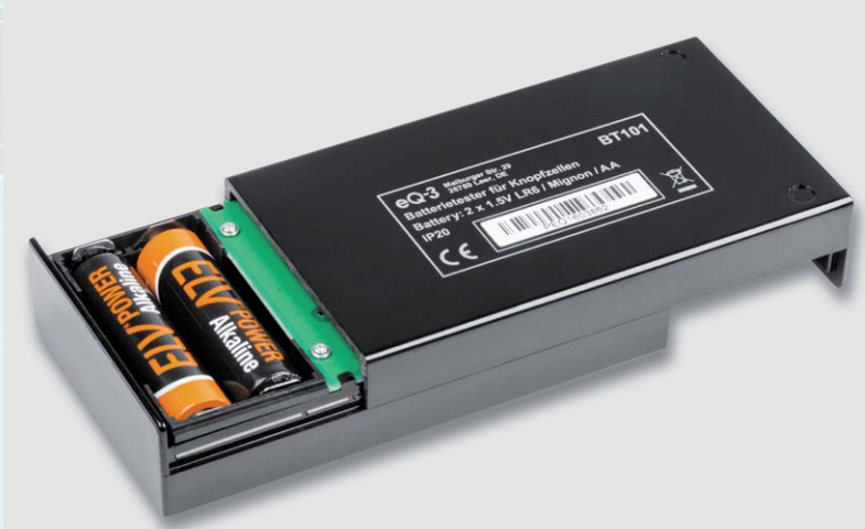
Bild 19: Nach dem polrichtigen Einlegen der Batterien ...
