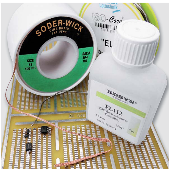
Bild 7: Erste Übungen mit dem Heißluftgerät können mit ausgelöteten, defekten Bauteilen auf einer Universalplatine stattfinden. Hier sind auch einige der benötigten Materialien, feines Lötzinn, Entlötlitze und Flussmittel zu sehen.
