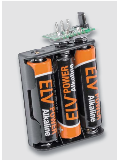
Bild 8: Fertig aufgebautes Modul, aufgesteckt auf einen Batteriehalter
