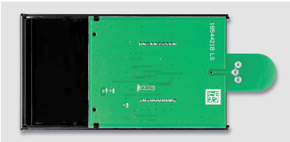
Bild 12: Nach dem Einlegen der Basisplatine mit aufgesteckter Displayplatine müssen die Anschlüsse der Stiftleiste gleichmäßig in der Basisplatine stehen.
