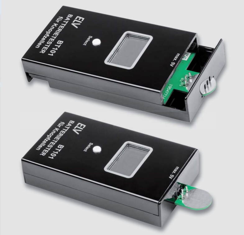
Bild 20: ... werden die Gehäusehälften bis zum Anschlag zusammengeschoben.
