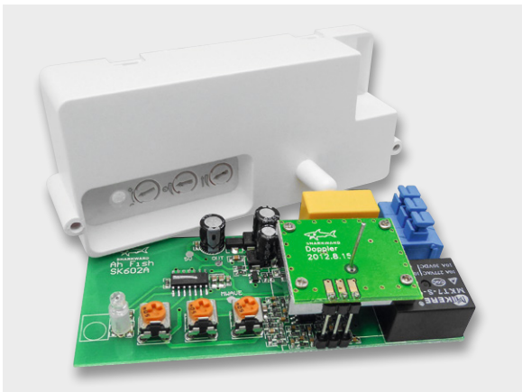
Bild 10: Ein typischer HF-Bewegungsmelder aus dem Nachrüstbereich. Rechts ist der Doppler-HF-Sensor zu sehen.
