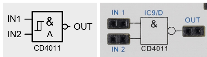
Bild 10: Nand-Gatter mit dem zugehörigen Platinaufdruck
