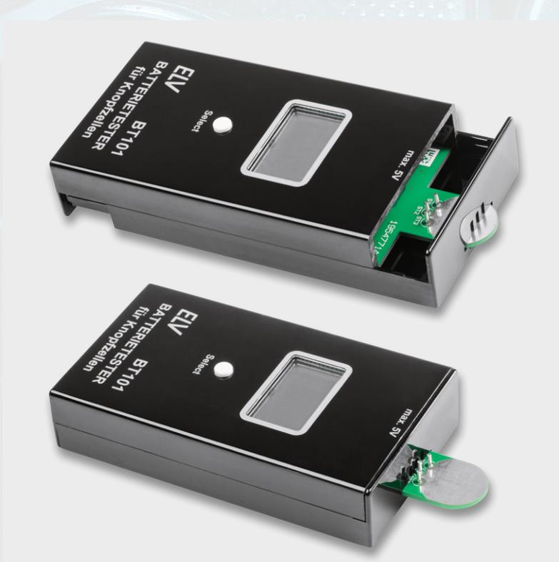
Bild 20: ... werden die Gehäusenhälften bis zum Anschlag zusammengeschoben.
