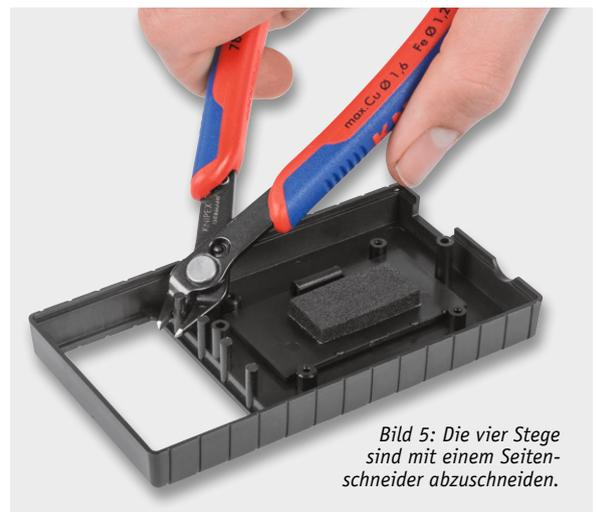
Bild 5: Die vier Stege sind mit einem Seitenschneider abzuschneiden.
