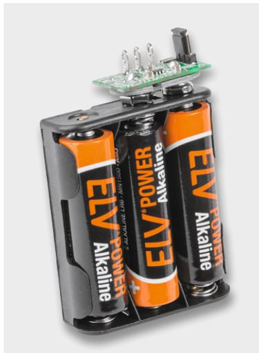
Bild 8: Fertig aufgebautes Modul, aufgesteckt auf einen Batteriehalter
