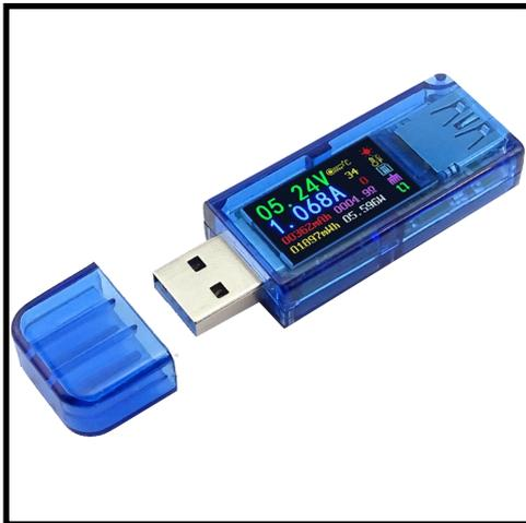
Das AT-34 ist ein kleines aber multifunktionell einsetzbares USB-Multimeter. Durch die Unterstützung aktueller Quick Charge Standards kann es auch problemlos in Verbindung mit aktueller Handheldhardware eingesetzt werden.
