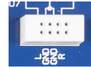
Bild 2: Mini-Steckboard zur Kontaktierung der Komponenten auf dem Board
