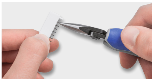
Bild 12: Vor dem Einsetzen der Mini-Steckboards sollten die Anschlussstifte auf geraden Sitz geprüft werden.
