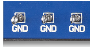
Bild 10: Massepunkte (Lötösen) erlauben den bequemen Anschluss von Messgeräten (GND-Anschluss)
