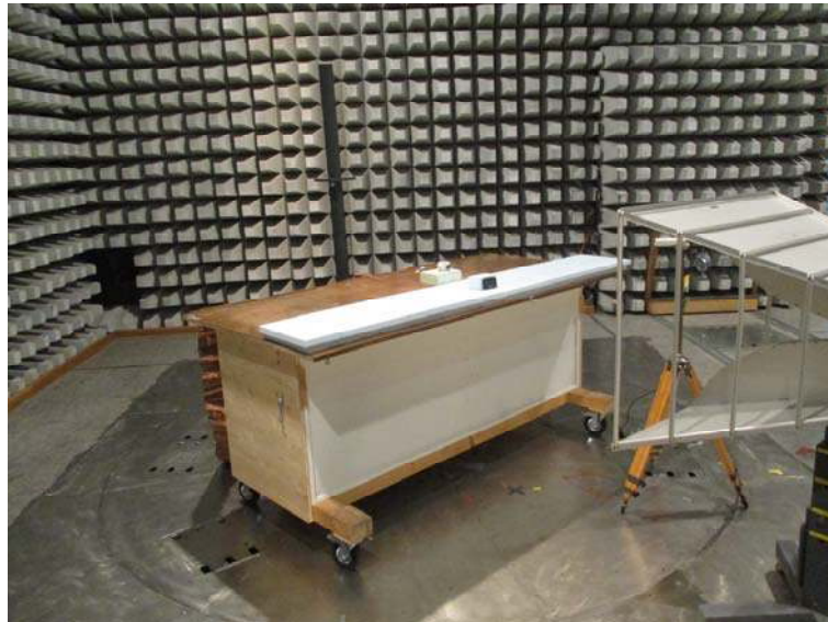
Messaufbau in der Messzelle / Test setup in the anechoic chamber (200 – 1000 MHz)
