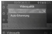
**Auswahl der AV-Aufnahmeauflösung:** 640x480, Im Modus „Auto-Erkennung“ wird die optimale Auflösung durch den Grabstar PRO automatisch gewählt und die Aufnahme in dem Format 720x576 oder 720x480 gespeichert. Eine Einflussnahme bezüglich des Formates bei der Auto-Erkennung ist nicht möglich.
