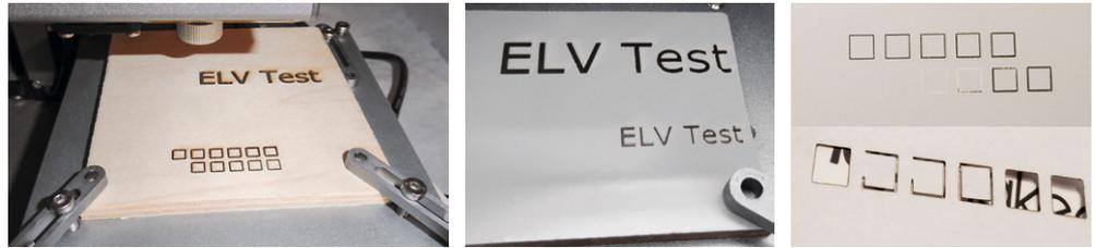
Bild 20: Der Schnittversuch im Moosgummi – wo die Einstelltiefe stimmt, ergeben sich glatte und präzise Schmitte.
