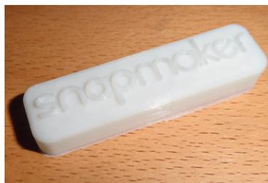
Bild 11: Schneller Test-Druck – die Musterdatei wird in ein bereits ansehliches Druckstück „umgewandelt“.
