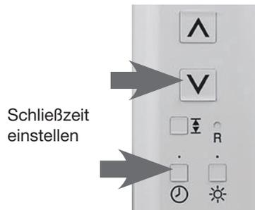
3. Zum Aktivieren des Timers drücken Sie ca. 3 Sekunden die Timertaste bis die LED über der Timertaste dauerhaft rot aufleuchtet.
