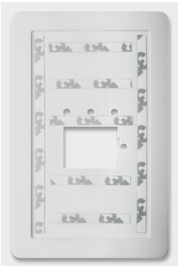
Bild 10: So wird das Gehäuse mit den Klebestreifen vorbereitet.
