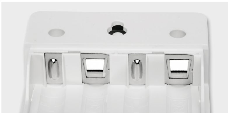
Bild 13: Hier sind beide Batterie-Brückenkontakte eingesetzt.
