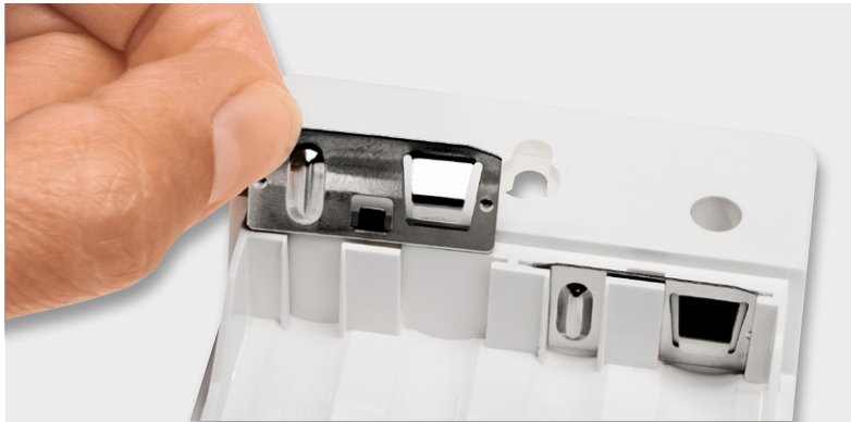
Bild 12: Das Einsetzen der Batterie-Brückenkontakte
