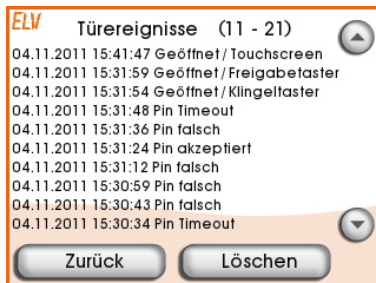
Bild 21: Die in der Datei doorlogging.xml implementierte Ereignisliste
