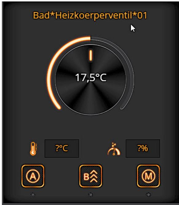
Bild 3: Widget für Heizkörperventil
