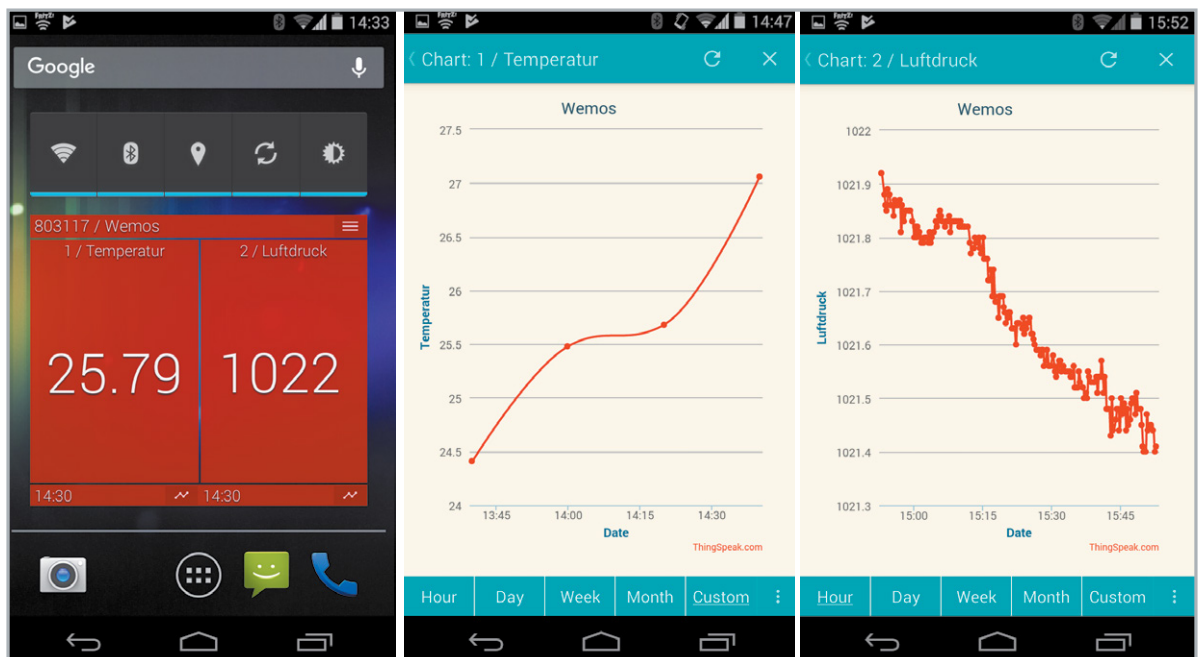
Bild 24: Das Widget „IoT ThingSpeak Monitor“ zeigt die Momentanwerte, aber auch geloggte Werte an.
