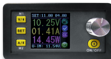
Bild 2: Das kleine Farbdisplay informiert über alle aktuellen Daten und Zustände sowie Voreinstellungen.
