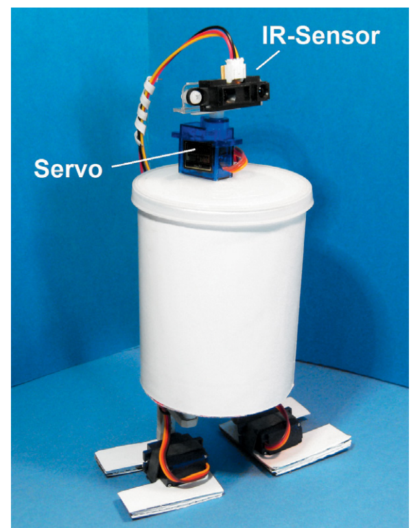
Bild 8: Walkbot mit zusätzlichem IR-Abstandssensor
