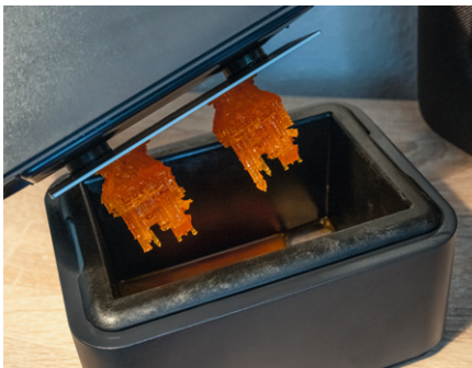
Hier sieht man die Bühne mit dem gedruckten Objekt und unten befindet sich der Tank mit dem restlichen Harz.
