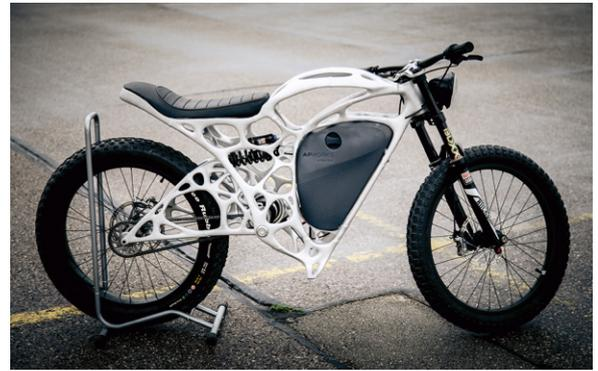
Bild 11: Der Light Rider von APWorks zeigt, dass auch komplizierteste Strukturen per 3D-Druck realisierbar sind. Foto: APWorks
