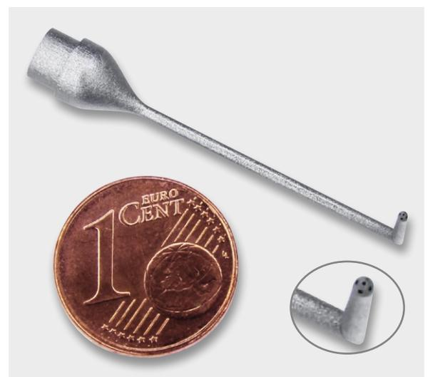
Bild 21: Mit der Beherrschung des Micro-Laser-Sinter-Prozesses sind auch im Sinterbereich mikrofeine Strukturen realisierbar. Foto: 3D MicroPrint
