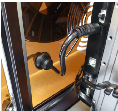
Bild 9: Der Entstörfilter des Stromversorgungskabels passt genau in die Gummidurchführung für das Kabel.
