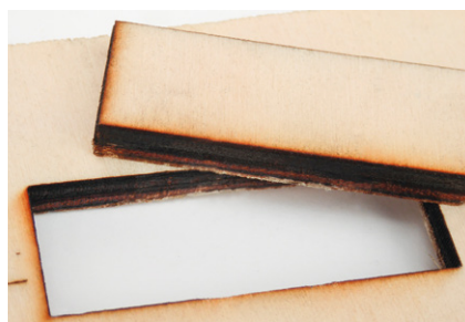
Bild 14: In den Programmeinstellungen kann man die Anzahl der Durchgänge, den Vorschub und weitere Bedingungen genau nach Material festlegen.
