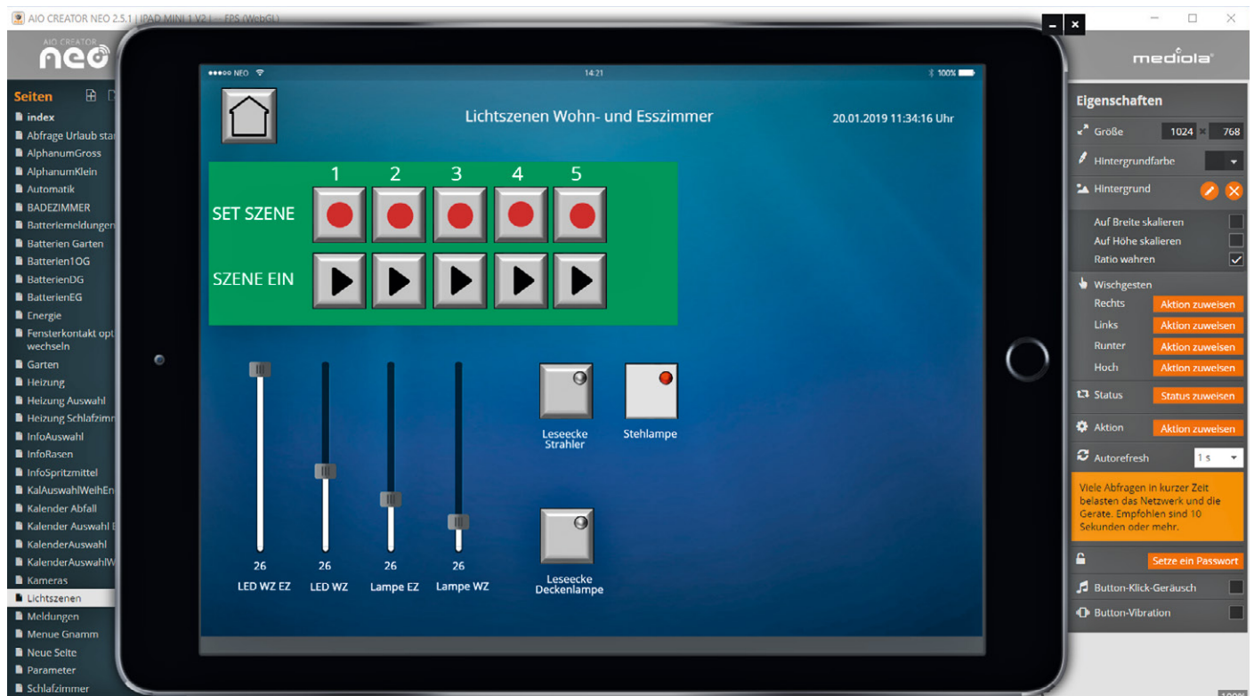
Bild 5: Demomodus einer Seite mit teilweise selbst designten Elementen. (Der CREATOR zeigt lauffähige Seiten der Fernbedienung auf einer simulierten Zielsystemumgebung.)
