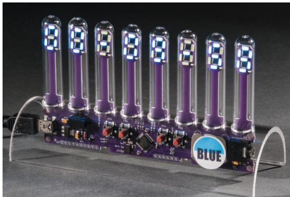
Bild 12: Mit blau leuchtender, im VFD-Stil ausgeführter Anzeige – die Tube Clock.
