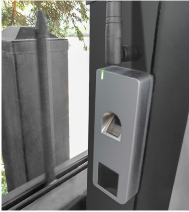
Bild 4: Automatischer Scanner, hier der SF300, im Einsatz an einem elektrischen Hoftor. Er ist als IP66-Gerät für den harten Außeneinsatz geeignet und verfügt zusätzlich über einen RFID-Leser.
