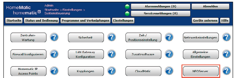
Bild 2: Über den Button „Neo-Server“ ist die Service-Seite des Add-ons zu erreichen.
