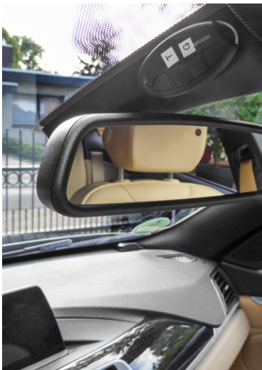
Bild 9: Mit solch einem Homematic Funksender kann man vom Auto aus Haustür, Garage oder das Hoftor öffnen.
