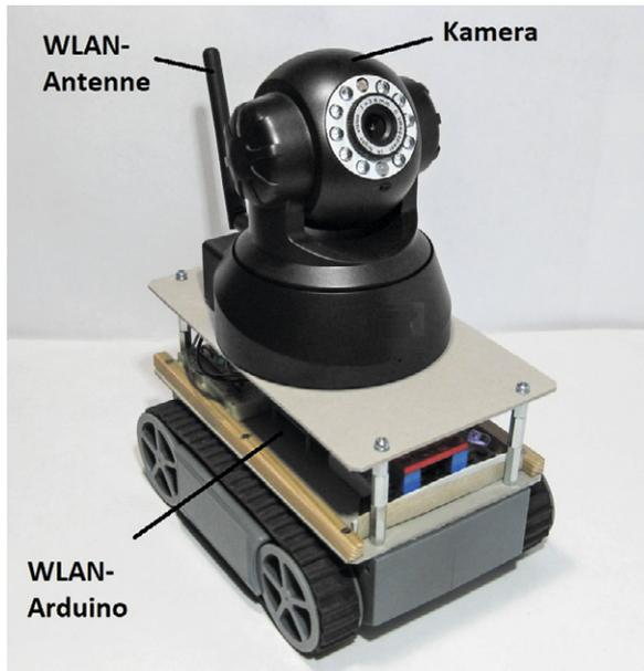
Bild 3: Roboterfahrzeug mit WLAN-Kamera
