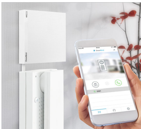
Bild 9: Ein Beispiel für eine IP-Anlage, hier die LAN-Video-Türsprechanlage DoorBird D2103V. Sie wird direkt an ein LAN-Kabel angeschlossen, kann aber auch über einen Konverter über eine Zweidrahtklingelleitung mit dem Netzwerk verbunden werden. Darüber erfolgt dann per PoE auch die Stromversorgung. Als „Innensprechstelle“ dient das Smartphone, das per WLAN oder Mobilfunkverbindung via Router mit der Türstation kommuniziert. Bewohner können hier auch per RFID-Key die Türschlossfunktion auslösen, und weitere Schaltausgänge steuern externe Geräte an. Bilder: DoorBird
