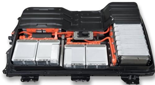
Bild 11: Typischer heutiger Lithium-Fahrzeug-Akku in einem Nissan Leaf. Bild: Nissan
