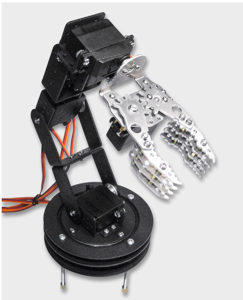
Bild 10: Über sechs Servos gesteuerter Roboterarm
