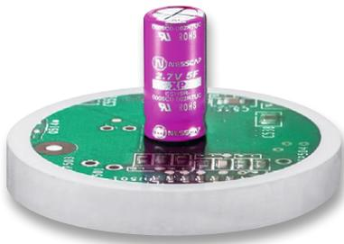
*Bild 4: Supercap mit hoher Kapazität für Backup- und Spitzenstrom-Anwendungen
