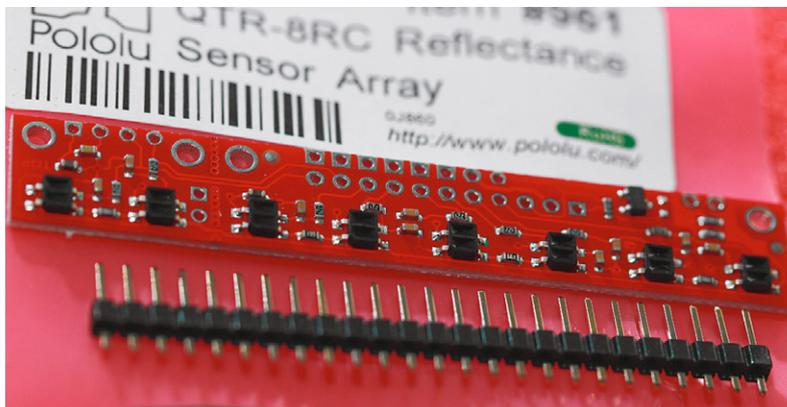
*Lange Pinleiste: Neben den acht IR-Sensoren werden neben der Spannungsversorgung auch die Masse sowie der Schalter für die IR-LEDs angeschlossen.*
