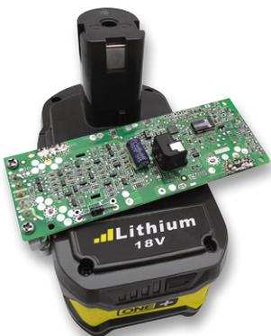
Bild 6: Aufwendiges BMS für einen 18-V-Werkzeugakku
