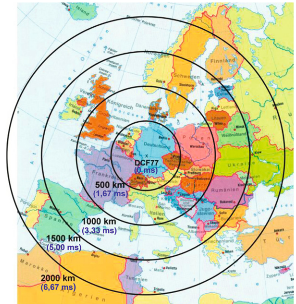
Bild 8: Die PTB Braunschweig verbreitet über den 75-kHz-Sender Mainflingen die amtliche Zeit der Bundesrepublik Deutschland in einem Umkreis von wenigstens 2000 km. Quelle: PTB
