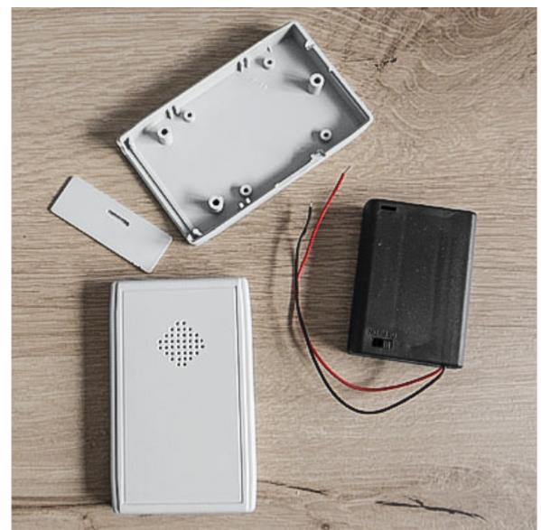
Bild 2: Das kompakte Gehäuse (hier schon bearbeitet) und der eingesetzte Batteriehalter
