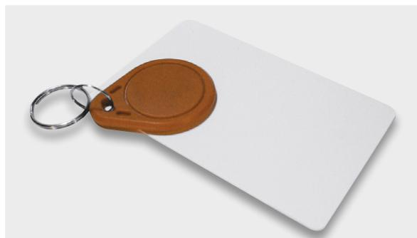
Bild 2: RFID-TAGs als Schlüsselanhänger und Keycard
