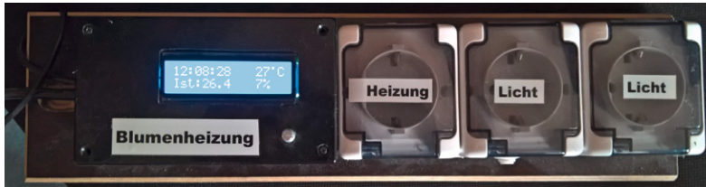
Bild 1: Die komplette Steuerung, gemeinsam mit den zugehörigen Netzsteckdosen auf einem Brett montiert
