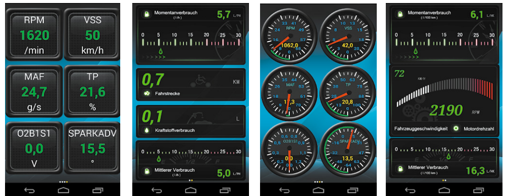
Bild 13: Typische Visualisierungsmöglichkeiten von Diagnose-Apps, hier der DNT-App auf unserer Testfahrt
