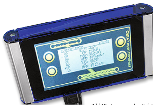
Bild 18: Im passenden Gehäuse untergebracht, hat man ein robustes, mobiles OBD-Gerät, das man über einen USB-Adapter auch aus dem Bordnetz versorgen kann.
