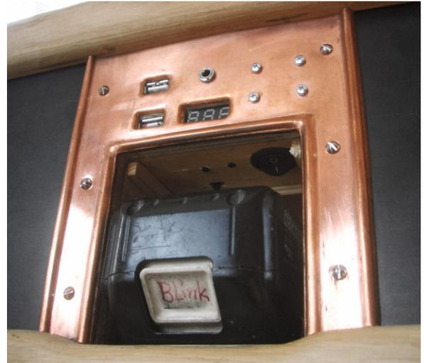
Bild 2: Die Geräterückseite mit Akkufach und Anschlüssen
