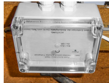
Bild 2: Mögliche Einbauvariante des Schaltaktors in das Gehäuse der Torsteuerung
