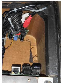
Bild 34: Der Cinch-Adapter am Raspberry Pi
