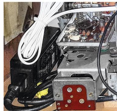
Bild 10: Das Notebook-Netzteil wurde mit im Gehäuse untergebracht.
