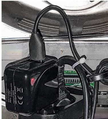
Bild 11: Das Display wird über ein eigenes 5-V-Netzteil versorgt.
