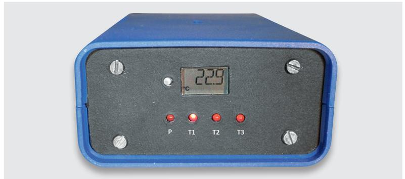
Bild 7: Eine Klima-Messstation mit I<sup>2</sup>C-Sensoren im Eigenbau
