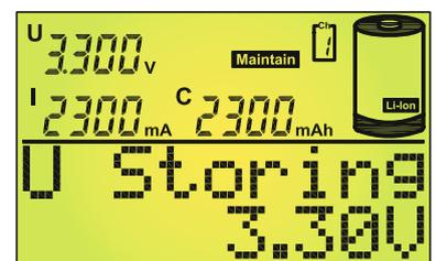
Bild 4: Spannungslage für die Einlagerung
