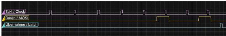
Bild 2: Signalverlauf 8-Bit-Schieberegister
