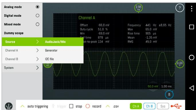
Bild 5: Oszilloskop Android (links Mikrofon als Input)
